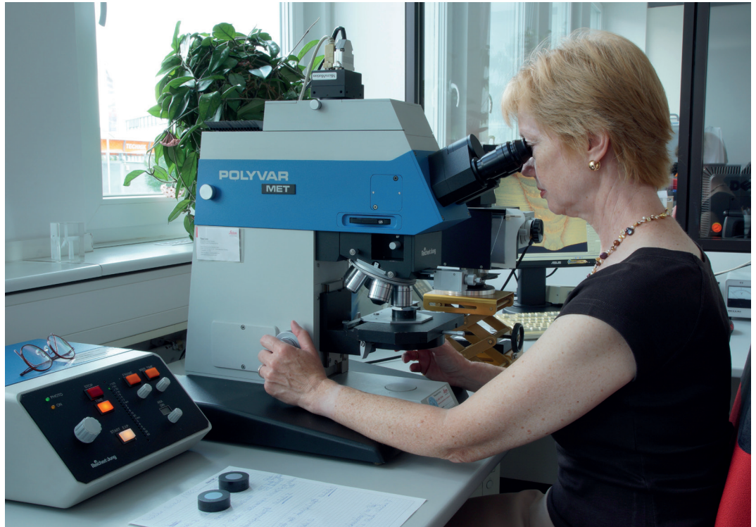
Bild 10: Die Gefügestruktur eines Stahls wird bei starker Vergrößerung beurteilt (Foto: Institut für Werkstoffuntersu- chungen, Essen (D))
